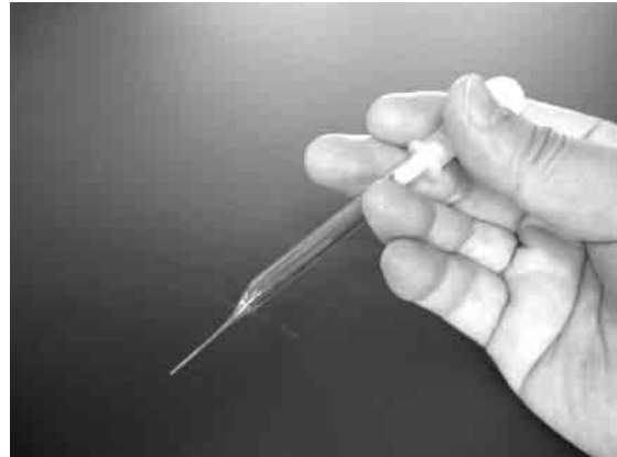
図2 ピペットの持ち方
